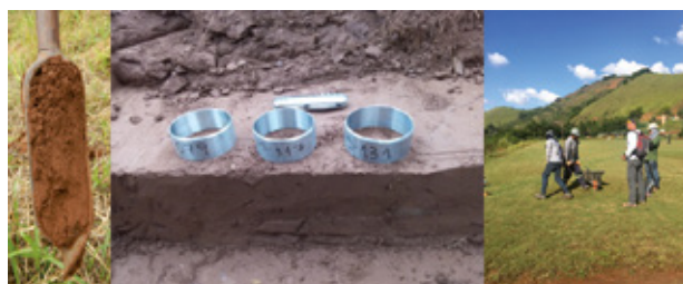
Figura 16 – Coleta de amostras deformadas e indeformadas de rejeito depositado, solo controle e misturas.
