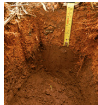
Figura 44 – Visualização, em campo, de uma camada de solo de áreas de empréstimo (indicada pela trena) depositado acima do rejeito.
